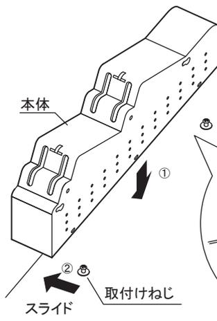
左図のように底板の2ヶ所のカギ型穴部を取付けねじに差し込み、本体を前板方向に軽くスライドさせると、固定されます。
