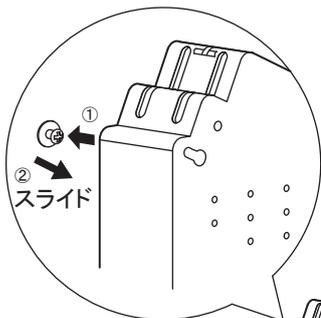
左図のように本体の2ヶ所のカギ型穴部を取付けねじに差し込み、本体を斜め下方に軽くスライドさせると、固定されます。
