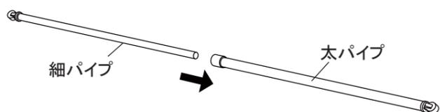
**11** アームの先端に竿端部のキャッチをはめます。（ロックがかかり、外れないことを確認してください。）反対側も同様に取り付けます。
