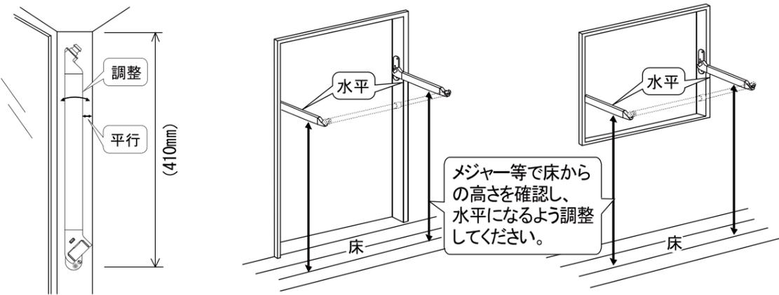
**7** 残りのタッピンねじを窓枠（額縁）にドリルで下穴を開けてから、プラスドライバーを使ってねじを最後までしっかり止めます。
