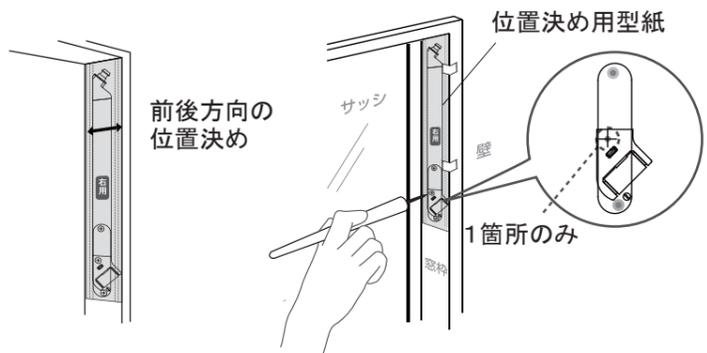
**4** 下穴に台座の穴を合わせ、プラスドライバーを使ってねじを最後までしっかり止めます。
